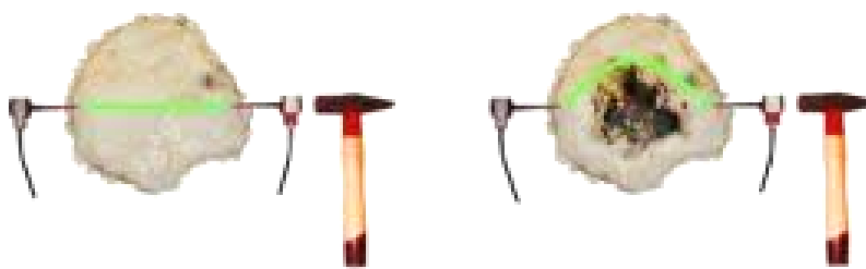
Figura 3. Schema di funzionamento del martello sonico.
